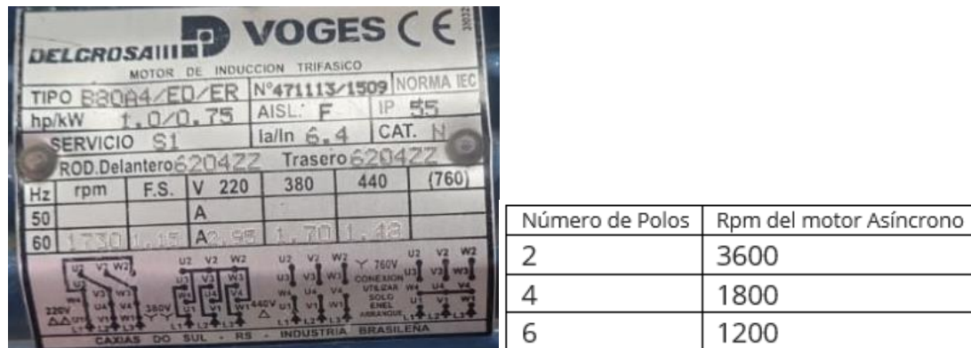
Figura 38 Placa de características motor trifásico
