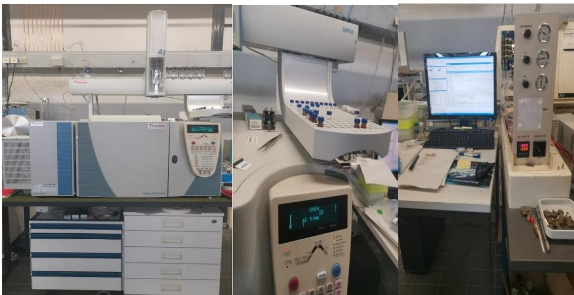
*Figura 28. Análisis de Isotopos  $\delta^2\text{H}_{\text{wax}}$  y  $\delta^{13}\text{C}_{\text{wax}}$  vía GC-MS.*
