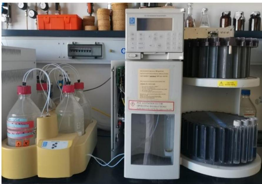
**Figura 20.** Extractor de solventes acelerado ASE200.
