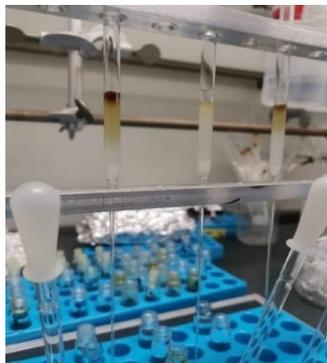
**Figura 24.** Separación de componentes vía columna.
