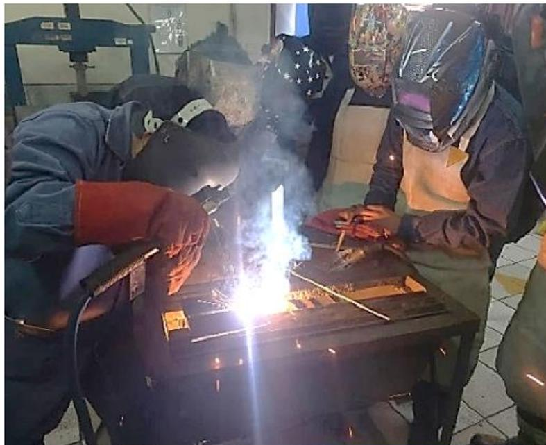
*Nota:* En la figura 14, el instructor realiza la demostración de la tarea de la soldadura a tope en “V” posición plana.
