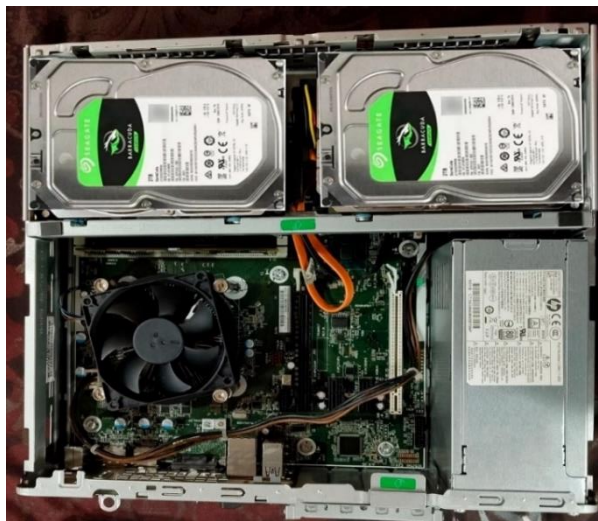
Figura N° 05: PC instructores– conexión en espejo
