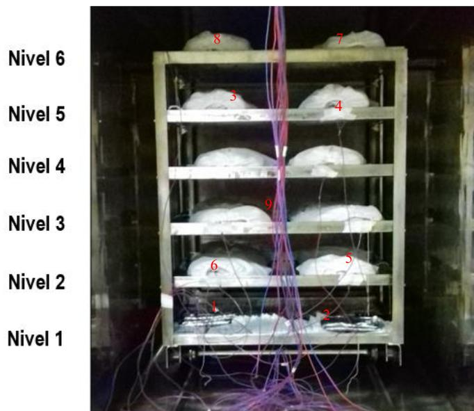
Figura 6 -Distribución de sensores e inóculos dentro de la carga hospitalaria
