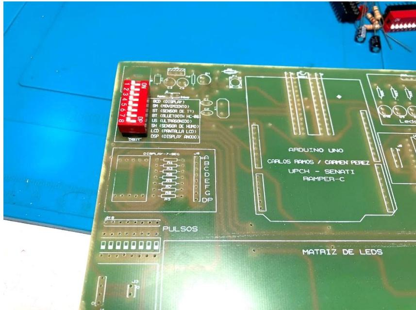
Nota: se realizó una limpieza de la tarjeta y se comenzó a colocar los componentes, para verificar los tamaños reales y errores que podrían existir
