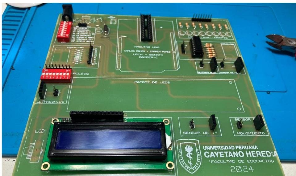
Nota: después de soldar se hace las mediciones respectivas para no encontrar cortos en la tarjeta electrónica
