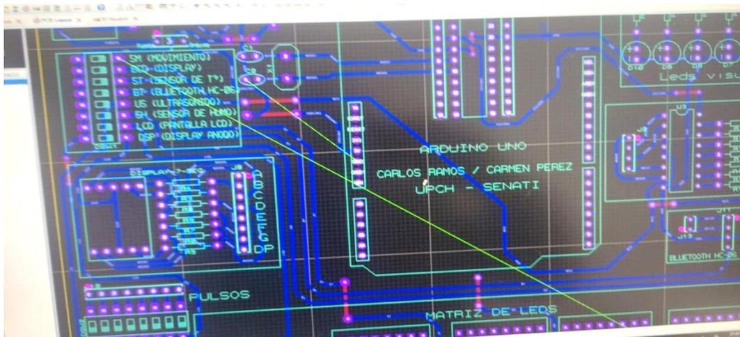
*Nota: se revisa las conexiones y se dibuja las pistas por donde se unirán los componentes.*
