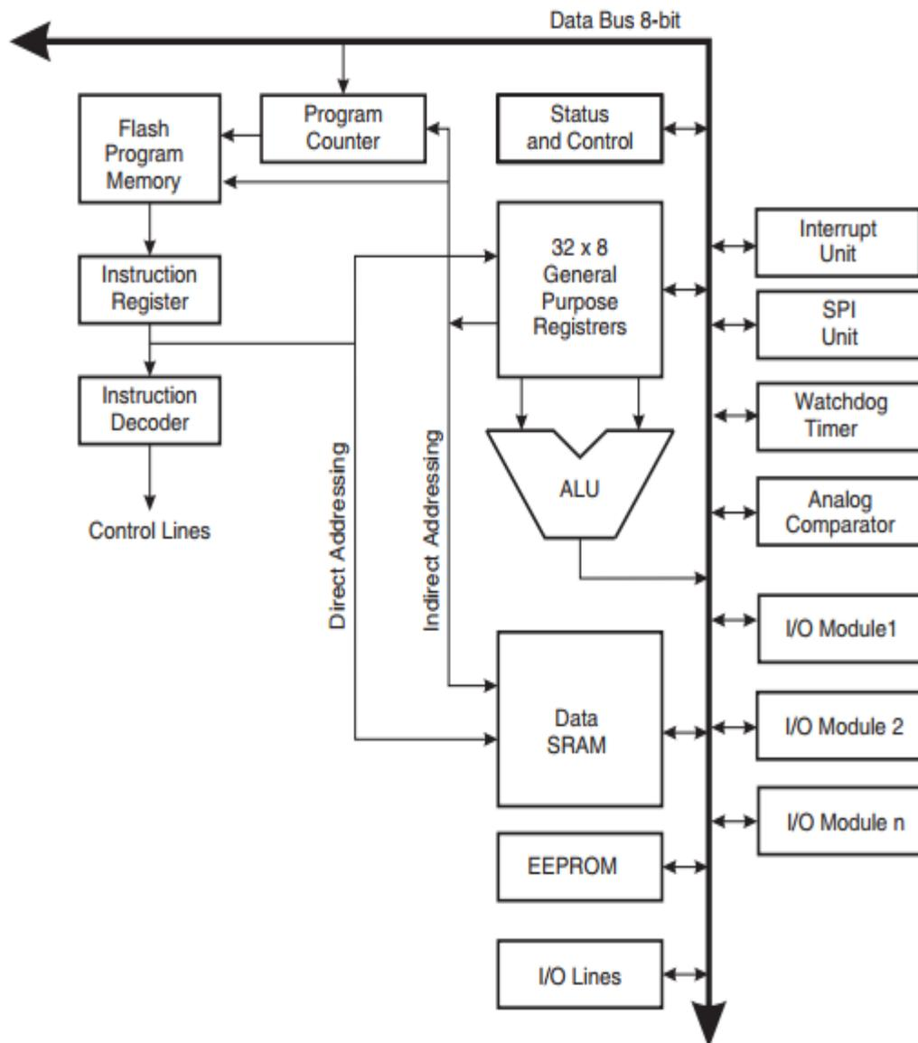
Nota: se analiza el núcleo de la CPU del AVR, la ALU, el registro de estado, el puntero de pila, el manejo de interrupciones y el procesamiento de instrucciones. La función principal del núcleo de la CPU es garantizar la correcta ejecución del programa. La CPU del AVR es capaz de acceder a memorias, realizar cálculos, controlar periféricos y manejar interrupciones Fuente: Datasheet AVR 328p de Atmel
