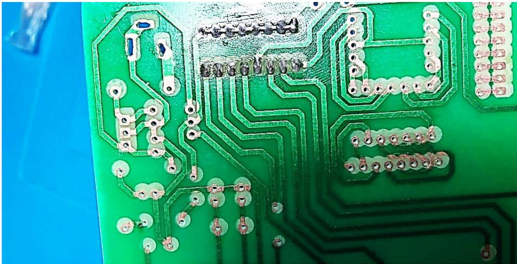
Nota: se comprueba la soldadura con el multímetro para verificar continuidad con las pistas.
