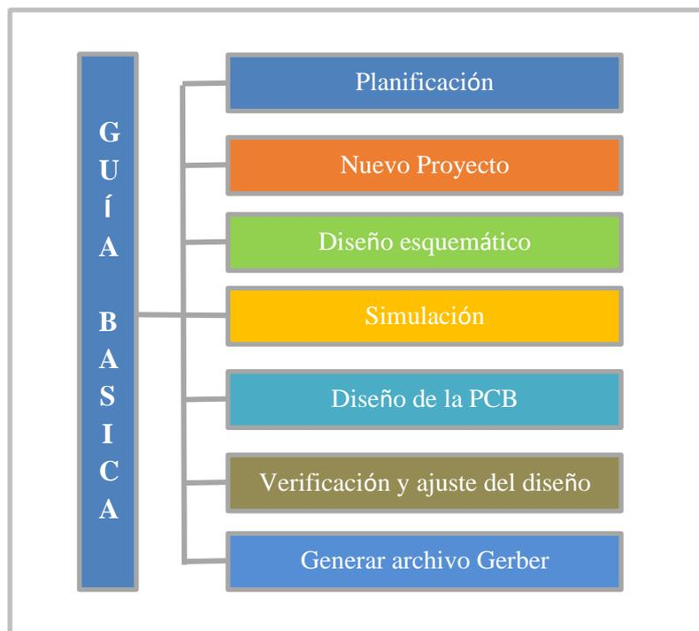
Nota: son los pasos que utilizaron para la fabricación de la tarjeta electrónica.
